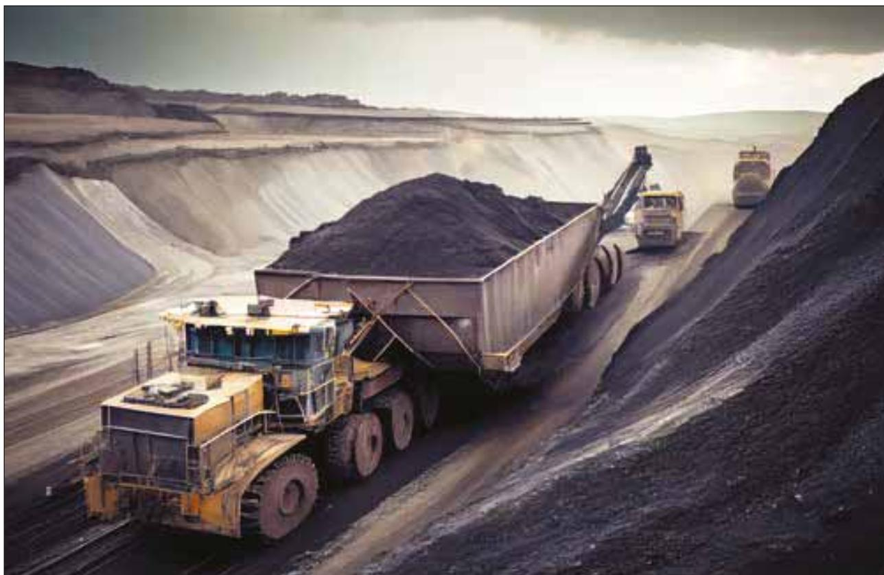
Remolque para el transporte de carbón fabricado con acero inoxidable 3CR12 suministrado por la factoría de Columbus Stainless
