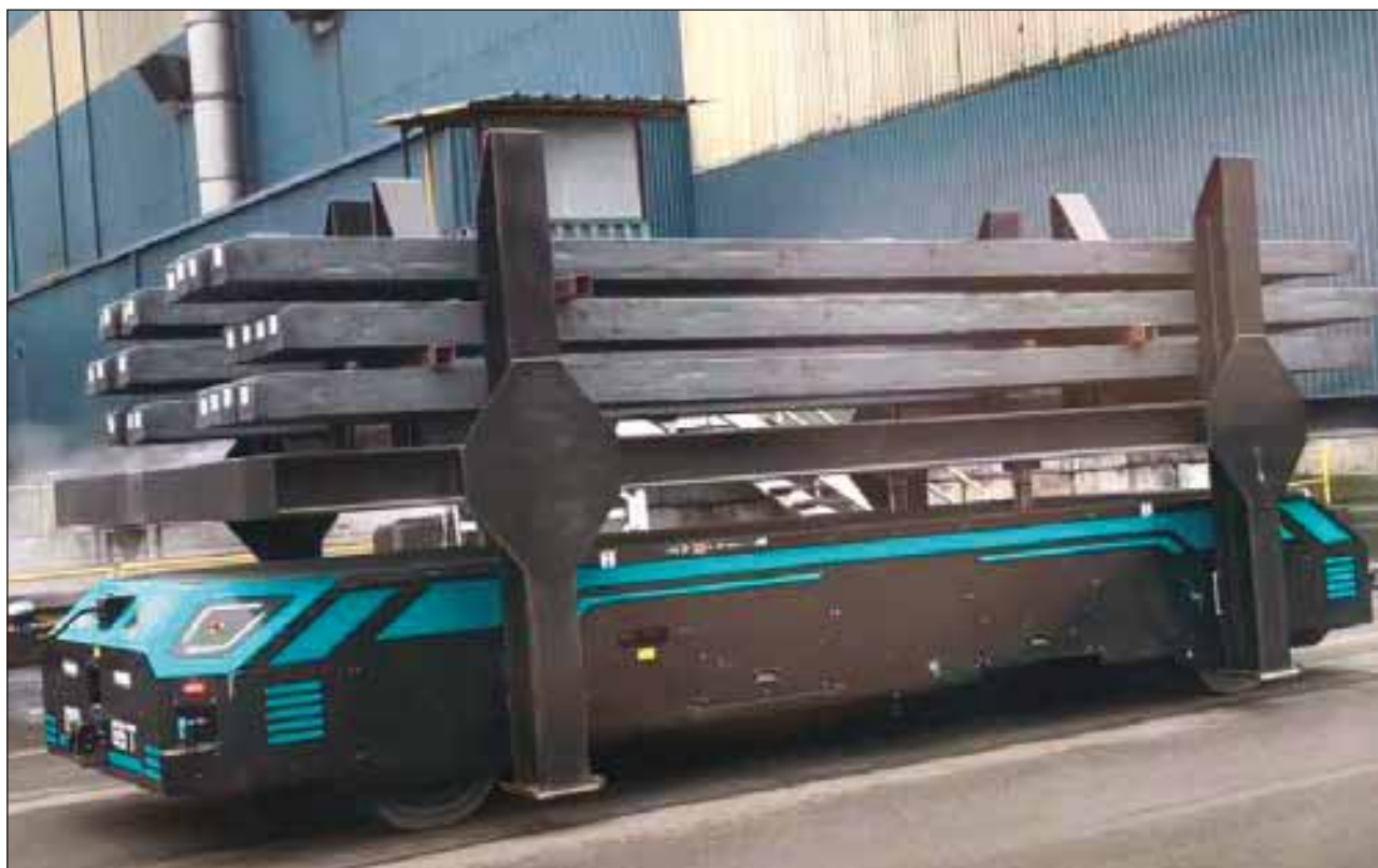
Vehículo Guiado Autónomo (AGV's), para el transporte de palanquilla en la factoría de NAS.
