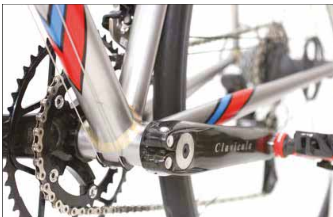
Cuadro de bicicleta fabricado con acero inoxidable.
