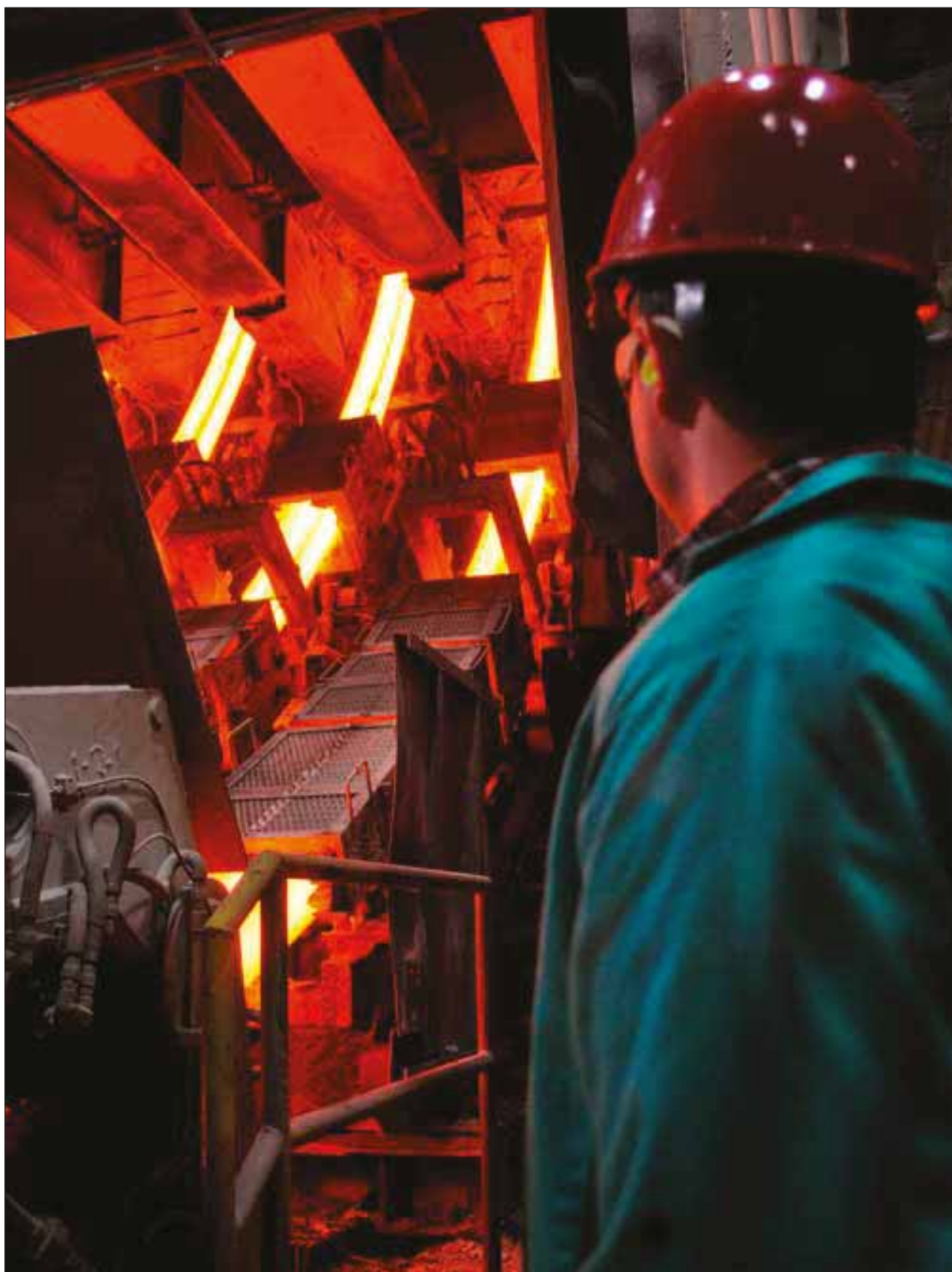
Colada continua de palanquilla en la factoría de NAS.
