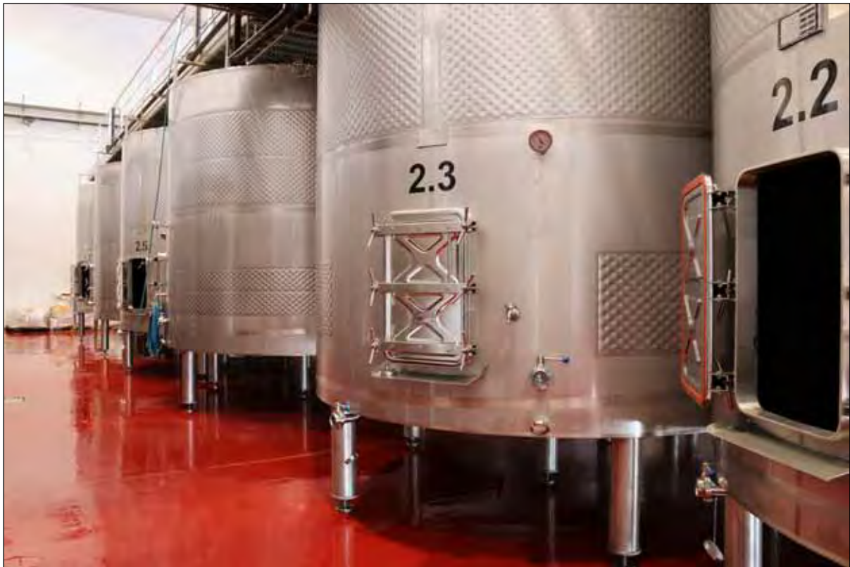
Tanques de vino fabricados con acero inoxidable.
