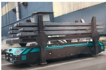
Se llevó a cabo una reingeniería de la automatización de la logística interna, para optimizar los recorridos de los AGV's en funcionamiento desde el 2021 en Acerinox Europa, así como la ampliación de las rutas para incrementar el uso de los equipos de movilidad autónoma.
