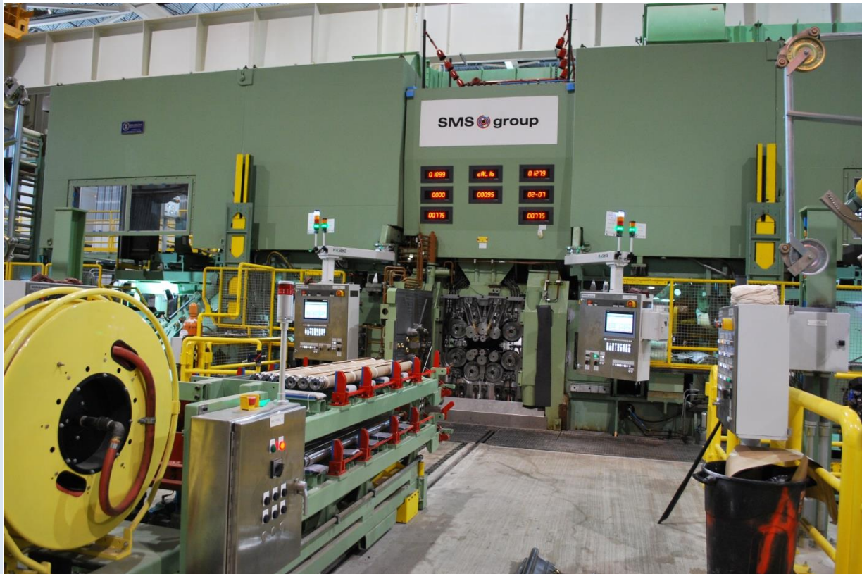
Nuevo laminador en frío de NAS
